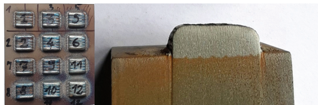
Fig. 1. Cross-section of the Stellite 1 joint with the WCL substrate Rys. 1. Przekrój połączenia Stellite 1 z podłożem WCL
