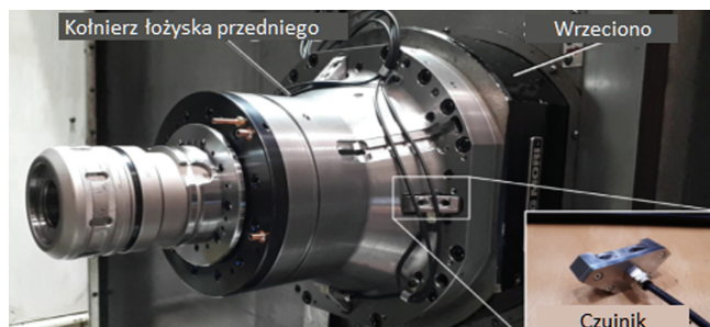
Rys. 2. Prototypowa instalacja układu pomiaru sił skrawania
