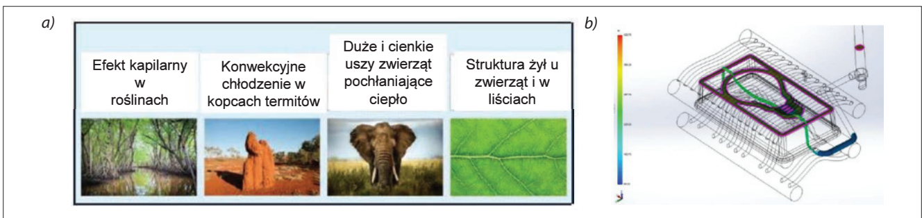
Fig. 5. Evaluation of biological systems (a) selected for optimization of conformal cooling channels in injection mould fabricated additively (b) [6] Rys. 5. Ewaluacja systemów biologicznych (a) wytypowanych do optymalizacji konforemnego systemu chłodzenia w formie wtryskowej wytwarzanej przyrostowo (b) [6]
