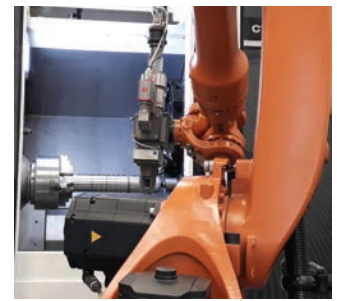
Fig. 1. Station for laser cutting support with attached element Rys. 1. Stanowisko do laserowego wspomaganie skrawania wraz z zamocowanym elementem
