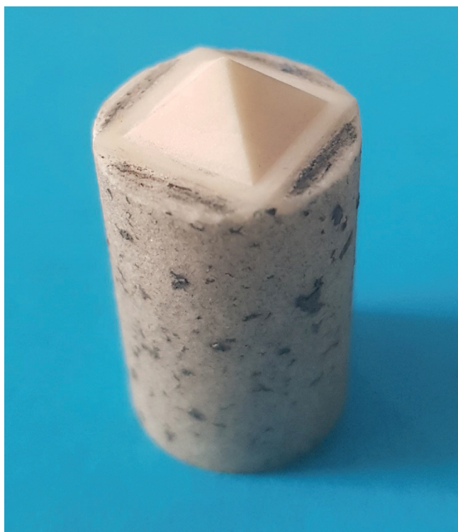
Fig. 9. Sample made with PCD05 tool ( v_c = 120 m/min, f_z = 0.05 mm/rev, a_p = 0.05 mm) Rys. 9. Próbkę wykonaną narzędziem PCD05 ( v_c = 120 m/min, f_z = 0,05 mm/obr, a_p = 0,05 mm)
