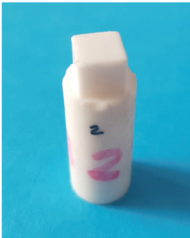
Fig. 8. Sample made with PCD10 tool ( v_c = 120 m/min, f_z = 0.05 mm/rev, a_p = 0.05 mm) Rys. 8. Próbkę wykonaną narzędziem PCD10 ( v_c = 120 m/min, f_z = 0,05 mm/obr, a_p = 0,05 mm)
