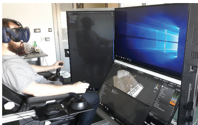
Rys. 6. Zdjęcie przedstawiające dwa systemy wyświetlania obrazu: gogle rzeczywistości wirtualnej HTC Vive (na głowie operatora) oraz zestaw monitorów obejmujących pole widzenia operatora żurawia. Na zdjęciu widoczne są również manipulatory używane do użytkownika żurawia
