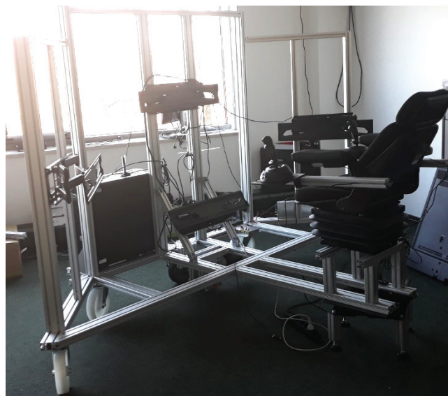
Rys. 3. Konstrukcja nośna symulatora żurawia wraz z fotelem operatora i uchwytami na telewizory
