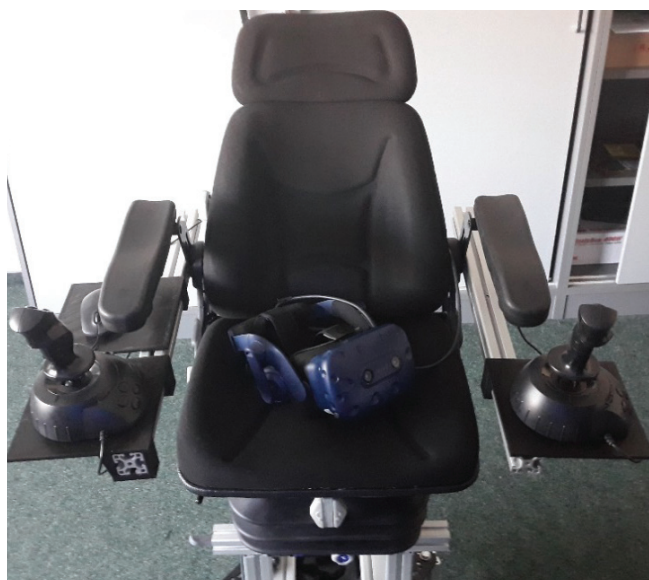
Rys. 5. Zdjęcie fotela operatora wraz z zestawem manipulatorów i goglami rzeczywistości wirtualnej
