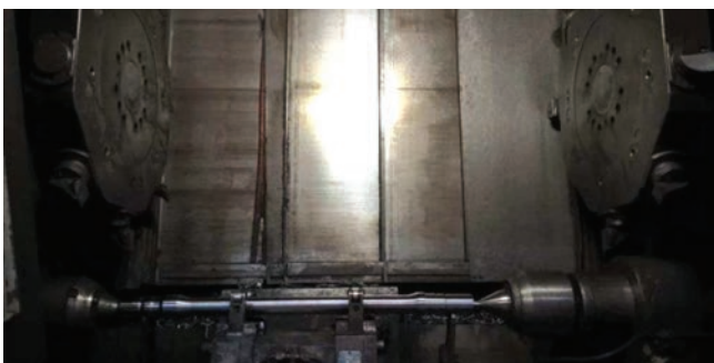
Rys. 5. Operacja toczenia na obrabiarce AFM Defum TAE45N
