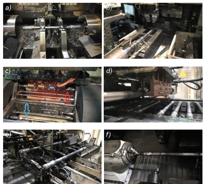
Rys. 4. Proces technologiczny półosi samochodowej: a) nakiełkowanie i toczenie czoł, b) walcowanie wielowypustów, c) hartowanie indukcyjne, d) odpuszczenie, e) prostowanie, f) toczenie na twardo
