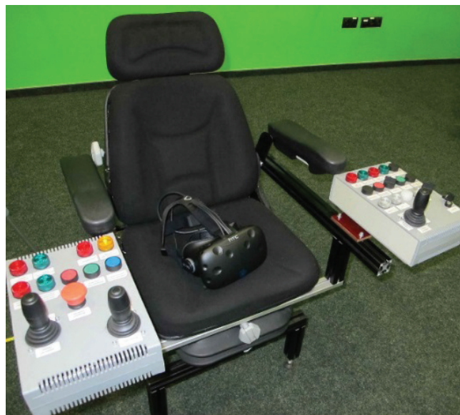
Rys. 2. Siedzisko z pulpitem sterowniczym symulatora suwnicy w wersji przenośnej
