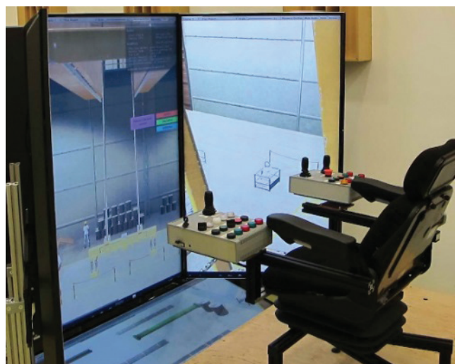
Rys. 3. Rozmieszczenie ekranów przed użytkownikiem symulatora suwnicy w wersji stacjonarnej
