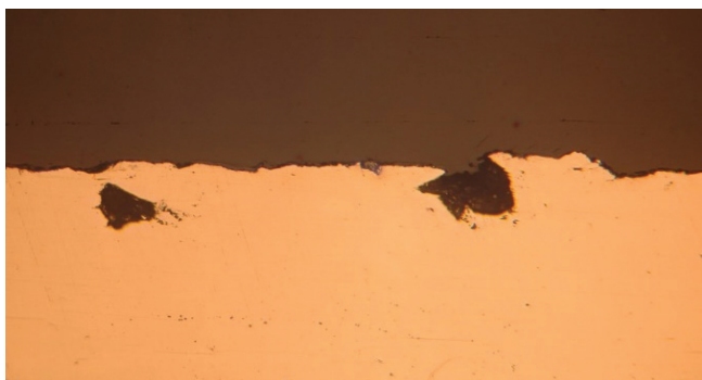
Rys. 6. Zgląd metalograficzny nietrawiony (rejon – odcinek prosty rury). Powiększenie 1000x. Widoczne uszkodzenie materiału w postaci dwóch wyraźnych ognisk korozyjnych
