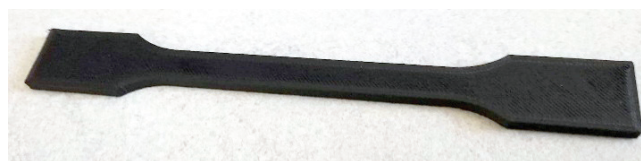
Rys. 3. Próбка do badań wytrzymałościowych wydrukowana metodą FDM
