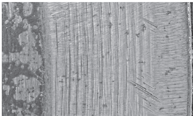
Rys. 3. Powierzchnia robocza noża tarczowego do cięcia gumy po półrocznej eksploatacji z widocznymi rysami (zdjęcie wykonane mikroskopem cyfrowym Keyence VHX 1000)
