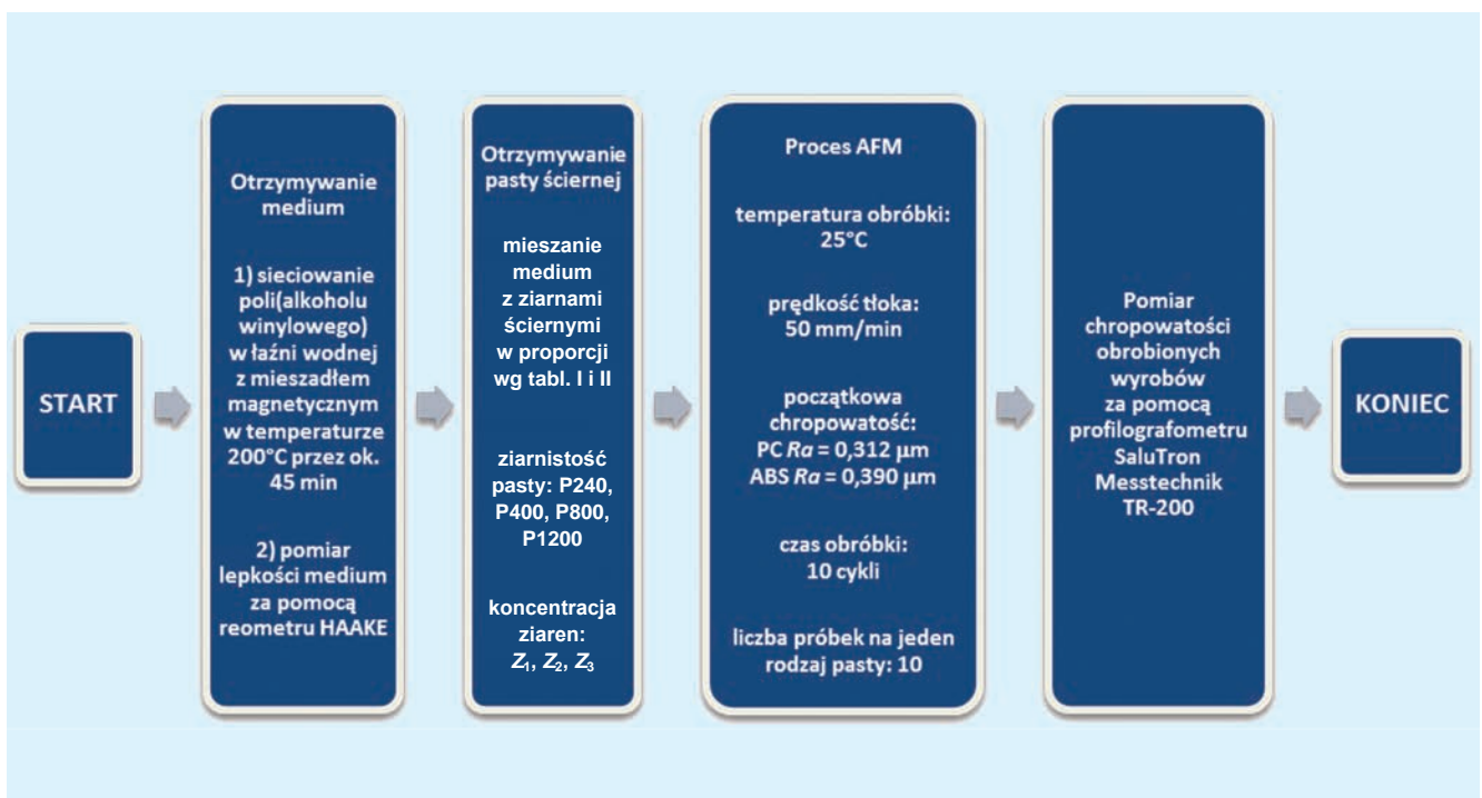
Rys. 4. Procedura przygotowania pasty ścierniej oraz realizacji procesu obróbki przetłoczno-ścierniej wyrobów polimerowych
