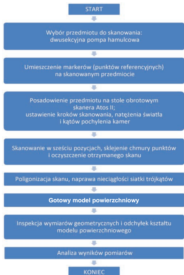
Rys. 1. Procedura budowania modelu powierzchniowego i inspekcji jego wymiarów na bazie skanowania przedmiotu rzeczywistego
