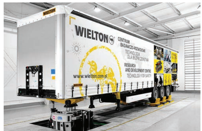
Rys. 2. Symulator drogi MTS 320 Road Simulator w firmie Wielton podczas badania trwałościowego naczepy kurtynowej
