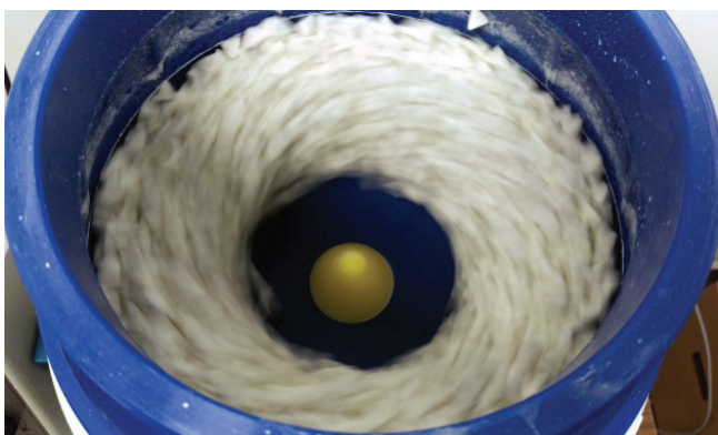
Rys. 7. Wirujące wkładki ceramiczne wyznaczające strefę roboczą w procesie wygładzania
