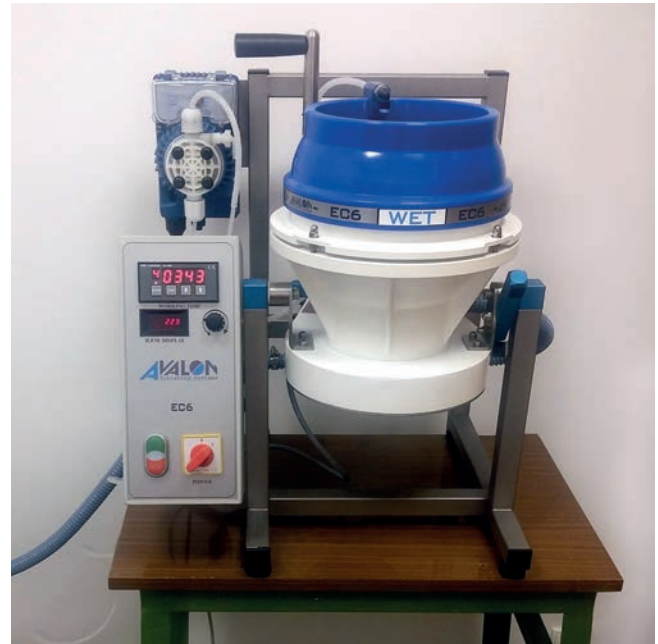
Rys. 4. Widok stanowiska badawczego składającego się z wyłazdarki rotacyjno-kaskadowej
