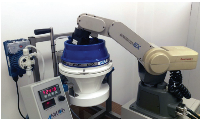
Rys. 6. Sterowanie położeniem próbki w bębnie wygładzarki za pomocą ramienia robota RV-M1
