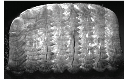
Rys. 3. Widok przeciętej powierzchni, próbka N3 z widocznymi pęknięciami w kierunku tworzenia warstw, pow. 7x
