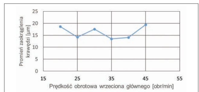
Rys. 5. Wpływ prędkości obrotowej wrzeciona głównego na promień zaokrąglenia krawędzi skrawającej
