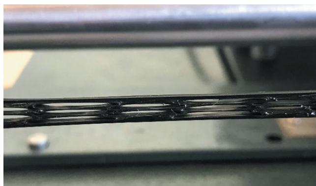
Rys. 8. Struktura próbki rozciąganej podczas badań wstępnych
