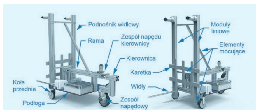
Rys. 1. Wizualizacja modelu CAD mobilnego robota transportowego
